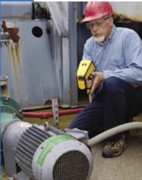
Ein Programm zur Vermeidung kostspieliger Ausfälle in Ihrem Betrieb kann durch die Einführung von Thermografie zur Überwachung des Zustands von Elektromotoren noch verbessert werden. Mit Hilfe einer tragbaren Wärmebildkamera können Sie das Temperaturprofil eines Motors in zweidimensionalen Bildern festhalten.
